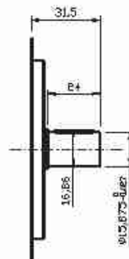
Type shaft SAEA-AC Albero tipo SAEA-AC Max torque / Coppia max 140 Nm
