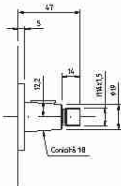
Type shaft 3-C9 Albero tipo 3-C9 Max torque / Coppia max: 320 Nm
