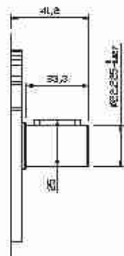
Type shaft SAEB-AC Albero tipo SAEB-AC Max torque / Coppia max: 450 Nm
