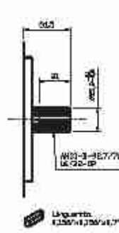
Type shaft SAEA-T9 Albero tipo SAEA-T9 Max torque / Coppia max 190 Nm
